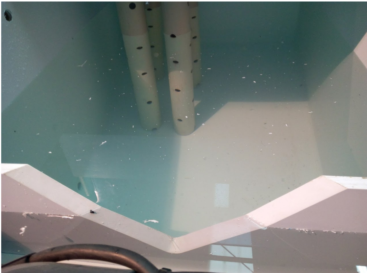
Figure 1 : Seuil amovible de type 1 avec (h, a) = (20 cm, 40 cm).
